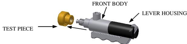
**NOTE: LEVER HOUSING POSITION CAN BE ADJUSTED BY NO MORE THEN ONE TURN (UNTHREADED) BACK FROM TIGHT AGAINST FRONT BODY.**
