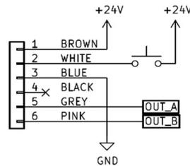
CV04SSR Wiring Diagram
